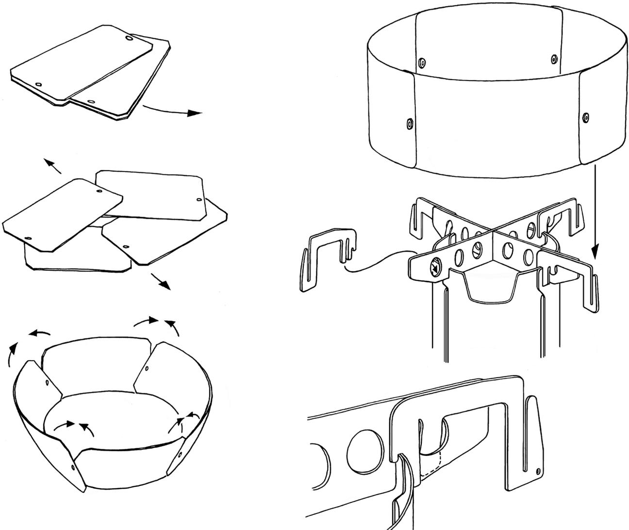
Der vierteilige Windschutz aus Aluminiumblech, wird mit Blechklammern am FIBI-Stove befestigt.
